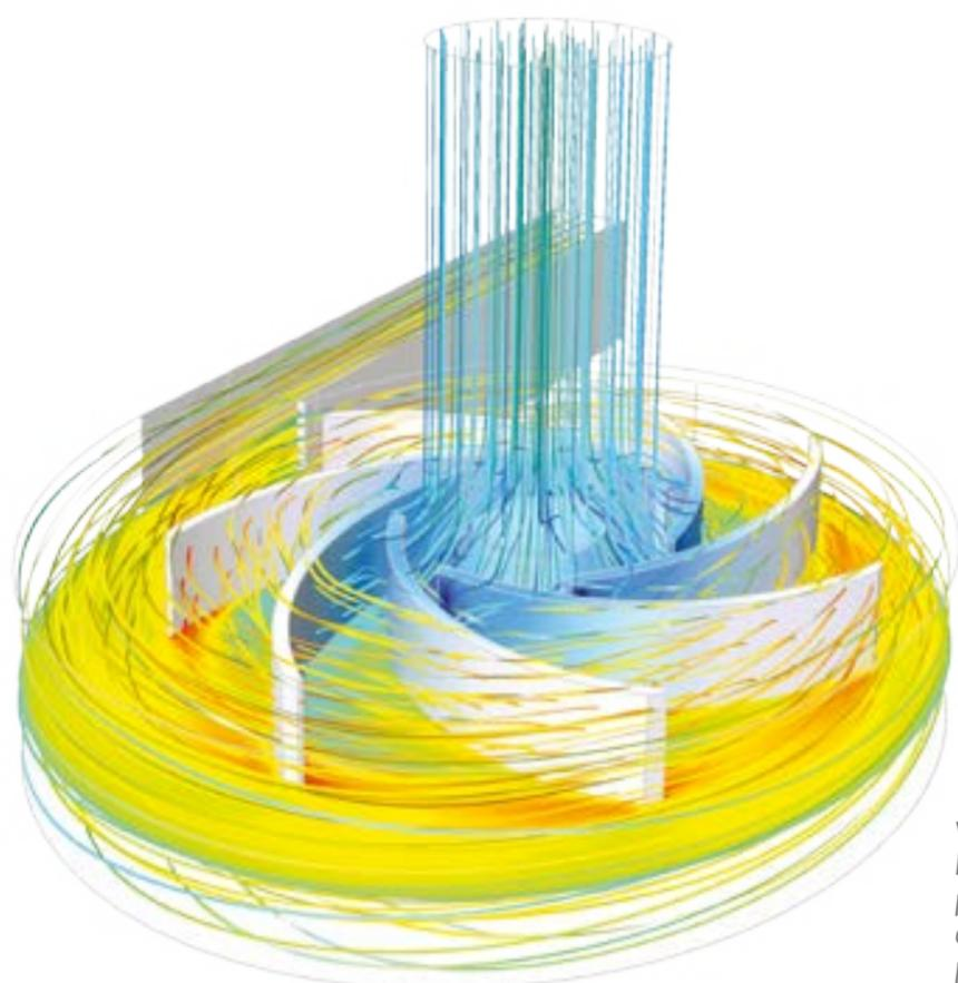
Visualizzazione delle linee di flusso, della pressione e del campo di velocità in una pompa centrifuga.
